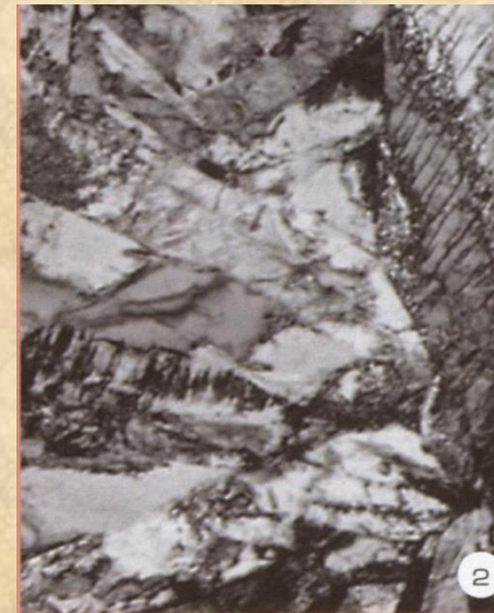
Struktura martenzytu listwowego z płytkowymi wydzieleniami Fe 3 C wewnątrz listew, pow. 19 000 x, TEM
